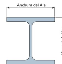
El dato más importante a la hora de seleccionar un carro, independientemente de la carga y del tipo de viga, es la anchura del ala de la misma.
