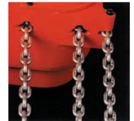
Detalle de la guía permanente de la cadena de carga.
